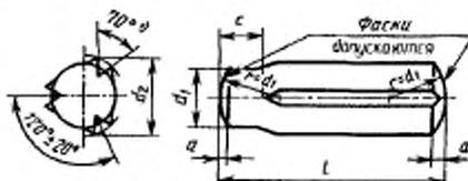
1) Угол насечки 70° применяется только на штифтах, изготовленных из стали, указанной в табл. 2. Угол насечки может изменяться в зависимости от пластичности материала.
